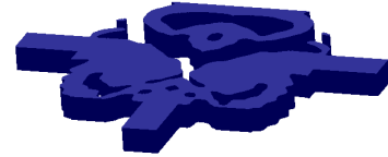
図 11: 最適化された T 分岐導波路の屈折率分布
