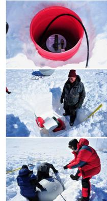
図3: ICESG観測点に設置された地震計(上)と設置の様子(中, 下)。
