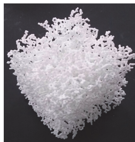
図 8 架橋フェノール樹脂の 3d-print。擬似架橋反応によるフェノール樹脂構造の形成シミュレーション (全原子 MD 計算) 結果を可視化している。京産業利用課題 (hp140097, hp150096, hp160089) 等と連携した住友ベークライトとの共同研究。
