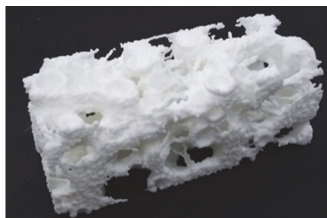
図 7 高分子ナノ構造の 3d-print。フィルラー充填高分子材料について、ポアソン比 0 で延伸させた場合の破壊挙動の粗視化 MD シミュレーションの結果について、可視化している。
