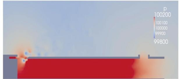
図 7 音孔をつけた 3 次元モデルでの圧力分布
