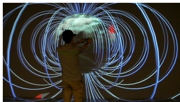
Fig. 3: Multiverse 環境に取り込んだ VFIVE アプリケーションによる地磁気 MHD ダイナモシミュレーションの可視化のスナップショット。青い曲線は双極子型の磁力線を示す。3 次元的な磁針（コンパス）が複数分布し、その内の一つは常に手元にある。CAVE の室内を移動すると、手元の磁場の変化と共にコンパスの向きが変わる。
