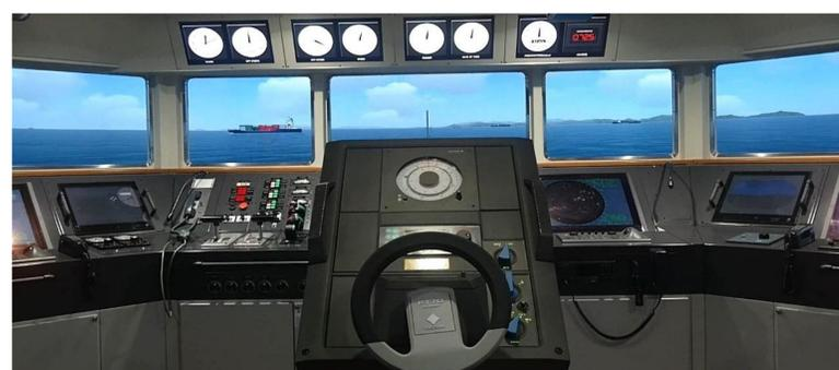
操船シミュレータを用いた自動操船実験
