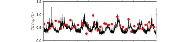
(5) 栄養塩の時系列分布図(赤丸が観測値、黒線がシミュレーション結果) EcoPARIでは窒素, リンなどの栄養塩の計算も可能である。また、植物プランクトンや動物プランクトンのシミュレーションも可能である。
