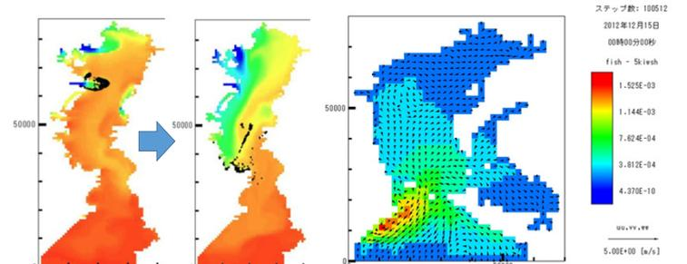
(3) 東京湾における粒子追跡結果。多摩川から放流された粒子(黒い点)が湾口の平分布図。外洋水のほうが温かいため、湾口付近に集中しているのが確認できる。
