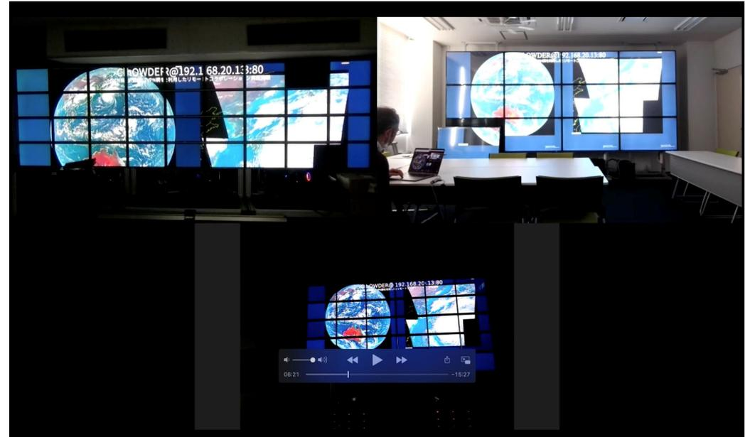
千葉大(左上)、九州大(右上)、NICT(下)のTDWを用いたひまわり衛星画像の超高解像度かつ時系列表示3拠点同時表示実験の様子:3拠点で同じ高解像度画像が同時に表示されている事例
