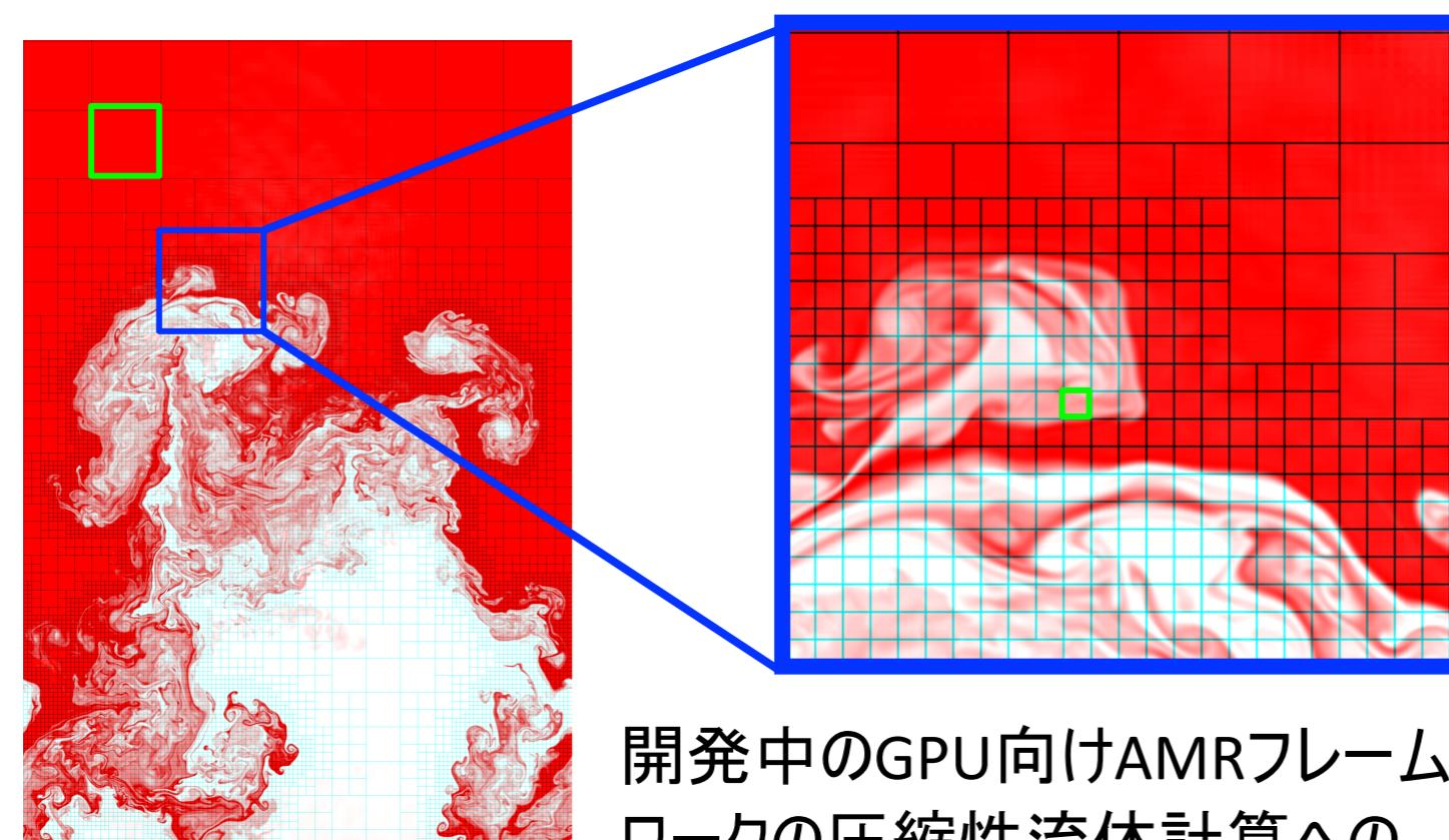
開発中のGPU向けAMRフレームワークの圧縮性流体計算への適用例。緑のブロックは同一数の格子点を持つ。
