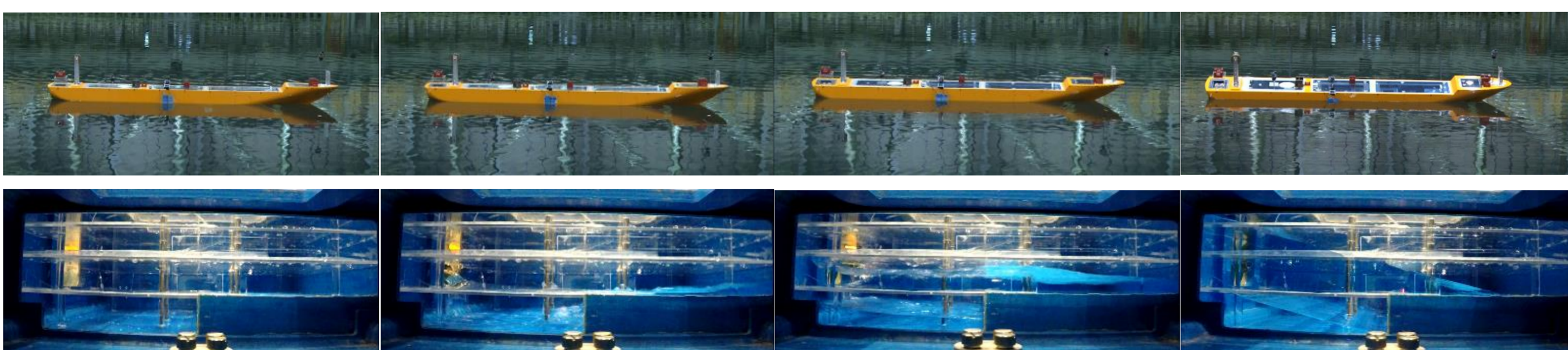
模型実験の結果(船体姿勢の変化と船内浸水の様子)
