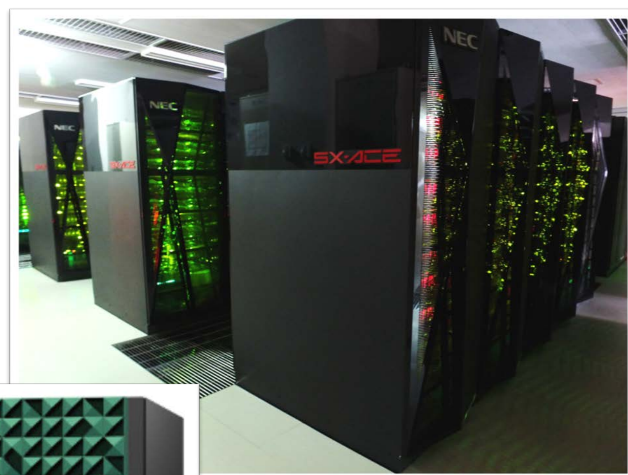
SX-ACEは1CPUに4coreで4CPU+64GBメモリで1nod構成。1B/Fとなっている。
