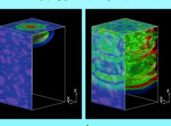
微小き裂群の開閉口に伴う非線 形超音波を検出することで、コン クリート自身の強度・健全性を評 価する. 材料非線形性あるいは 境界非線形性を考慮した動的有 限要素解析の適用を予定
