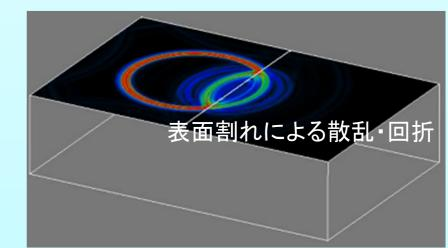
上図は、動弾性有限積分法(Elastodynamic FIT: EFIT)による弾性波の伝搬解析の例. 表層のき裂の深さを弾性波の透過振幅から推定する. EFITは陽解法であるので、並列化効率が良好であることが、H23,H24年度学際大規模情報基盤共同利用・共同研究拠点で示された. H25年度は現実的な形状・大きさをモデル化するための大規模計算を予定している(数十億ボクセル規模).
