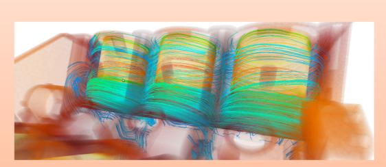
膨大な入力・出力データを効率的に扱うための技術を提供する。また、計算結果を3次元的に可視化し、視覚的にわかりやすく描画するため技術の実装をサポートする。上図は、有限要素法の計算結果を可視化(応力テンソルの超流線の表示)した例。
