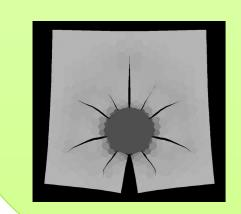
コンクリート,鉄筋,そして両材料間を付着領域として3相に分け、コンクリート材料中への塩化物イオンの拡散問題と鉄筋膨張に伴うき裂進展を含む力学問題の連成解析を実施する.非定常拡散解析と非線形有限要素解析を連成させて解く.数百万から数千万要素規模の解析を予定している.
