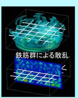
左図は、電磁界有限積分法 (Electromagnetic FIT: EMFIT)による床版の電磁波の伝搬解析の例. 鉄筋や塩ビ管の位置・分布形態を電磁波の散乱波形から映像化する. EMFITは陽解法であり、EFITと同じスキームでコーディングされているため、並列化効率は良好である. H25年度は現実的なモデル化のための大規模計算を予定している(数十億ボクセル規模).
