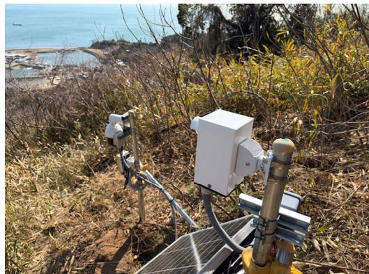
図4 電力自立型映像 IoT システム
