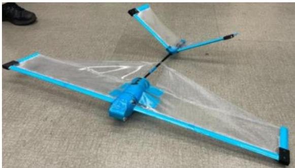
第 8 図 検討・製作した概念機。(上図：CAD によるイメージ，下図：収納性の試験を行うために製作した実証機)
