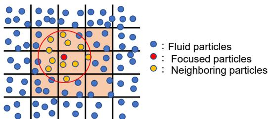
図 1 粒子法におけるバックグラウンドセル
