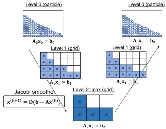
図 2 バックグラウンドセルを使った幾何マルチグリッドソルバ
