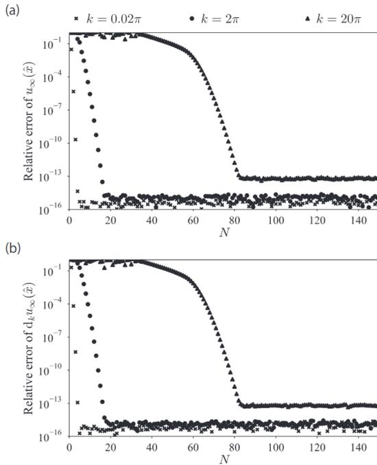
図1 指数オーダーの収束速度を持つ Kress の選点法を円盤型の散乱体による (a) 遠方場振幅の計算と (b) その周波数微分演算に適用. 文献 [3] より引用. 横軸の  $N$  は1つの散乱体に使用する選点の数を表す. 2次元の波動散乱問題をたかだか数十点の選点で  $10^{-13}$  程度の精度を達成.
