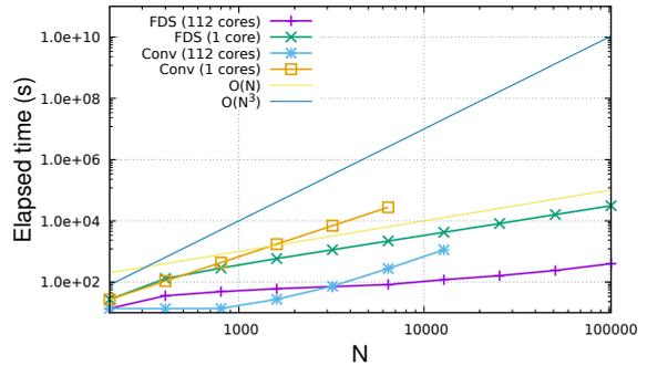
図2 問題規模に対する計算時間. 文献 [1] より引用.  $N$  は離散化後の節点数. 2次元の動弾性問題を  $O(N)$  の時間で解くことができる. また, 優れた強スケーリング並列性能が確認できる.
