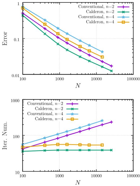
図3 (上) 数值実験に用いた2層構造を有する3次元散乱体の配置。(中) 解析解に対する相対誤差。(下) 散乱体の離散化数を増加させたときのGMRESの反復回数の変化。Conventionalは従来の定式化であり、Calderonが提案する改良型の定式化。文献[4]より引用。
