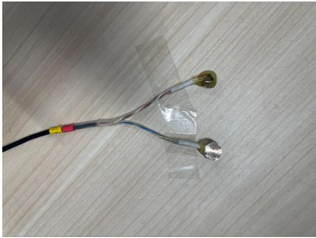
図2 従来研究において我々が筋電計測に利用していたセンサ
