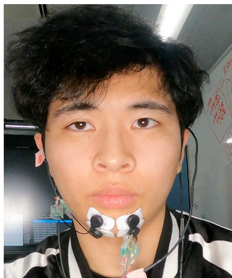
図 9 下顎部に左右対称に筋電センサを貼付けた例
