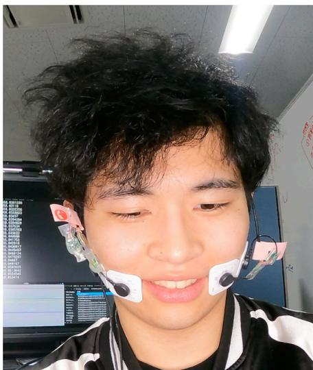
図 7 頬部に左右対称に筋電センサを貼付けた例
