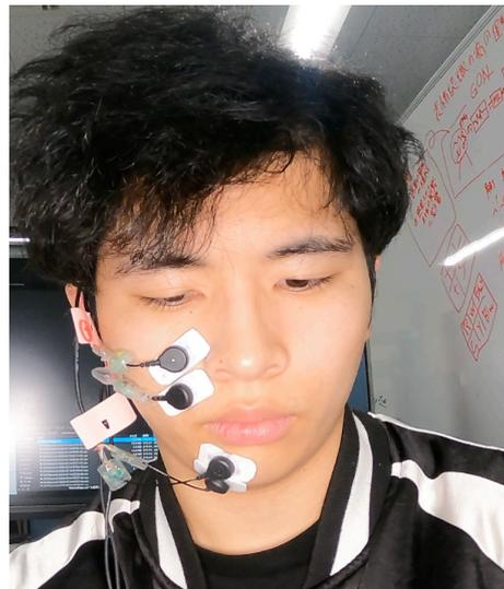
図 13 下顎頬部と鼻側部に筋電センサを貼付けた例
