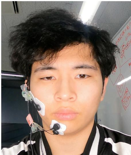
図 11 下顎頬部と頬部に筋電センサを貼付けた例
