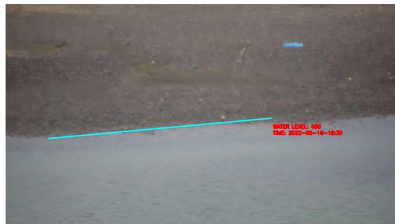
図 7-3. 映像 IoT 技術 : 独自アルゴリズムによる河川水位検出
