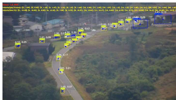
図 7-2. 映像 IoT 技術 : DeepSort 技術による車両検出
