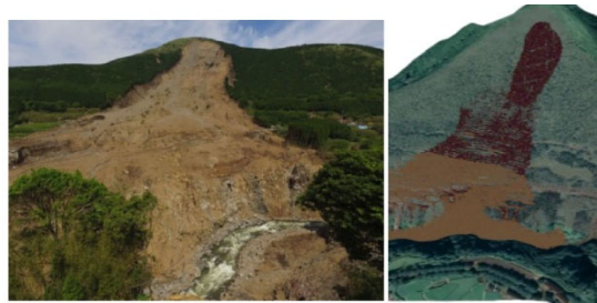
図 1 固体から高粘性流体へと相変化する粒子モデルによる熊本地震時の阿蘇の斜面崩壊の再現
