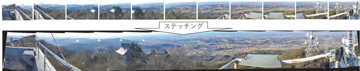
図 5-5 鳥の目カメラ画像特徴検出によるパノラマ写真再構成(ステッチング)
