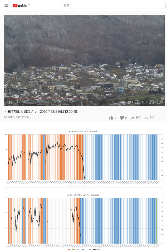
図 5-6 (上图)長野県千曲市の映像 IoT カメラによる降雪画像、(下图)画像処理技術による千曲市降雪自動検出結果: カラーバーは目視結果・グラフは雪片数の自動検出結果
