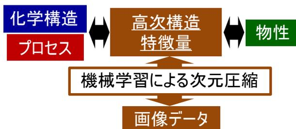
図 7. 放射光 X 線データの次元圧縮による特徴量抽出と階層的な構造物性相関
