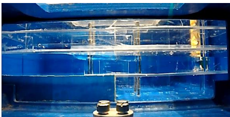
図 3 船内の浸水状況の様子
