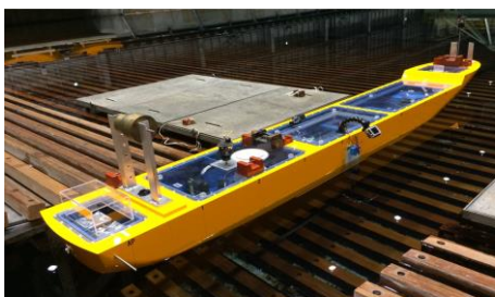
図 1 浸水実験に使用した模型船
