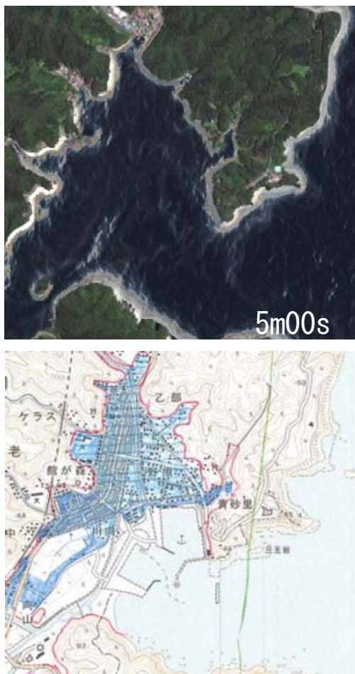
Fig.2: シミュレーションによる浸水領域 (上) と実際の浸水領域 (下) の比較
