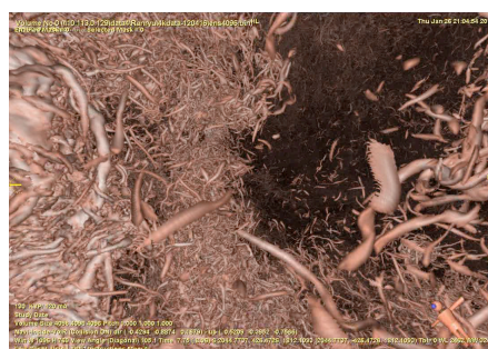
図 4: ソフトウェアによる高速ボリュームレンダリング手法(森)を用いた、格子点数 4096 3 の乱流中の高渦度領域の対話的可視化。全域(上)と没入時(下)の画像。
