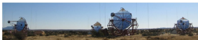
図 1. 撮像型チェレンコフ光望遠鏡。写真は南半球に設置されている H.E.S.S. (The High Energy Stereoscopic System)
